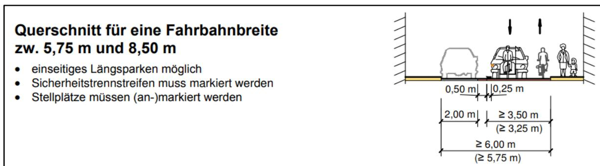
Bild: Querschnitt (Quelle: Musterlösungen für Radverkehrsanlagen in Baden-Württemberg)
