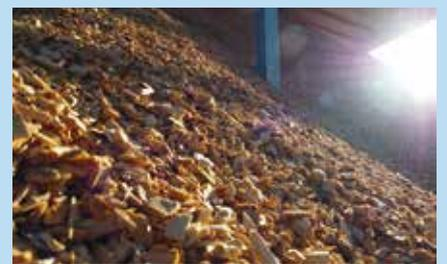
**Trocknung:** Circa sechs Monate lagern die Holz hackschnitzel und trocknen dabei an der Luft und an der Sonne. Es wird keine zusätzliche Energie für die Trocknung benötigt.
