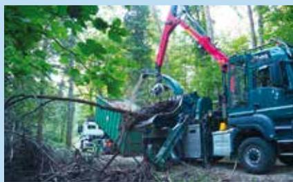
**Der Hacker:** Eine Spezialmaschine, der sogenannte Hacker, verarbeitet die Äste zu kleinen Holz hackschnitzeln und wirft sie über ein Gebläse direkt auf einen LKW-Container.
