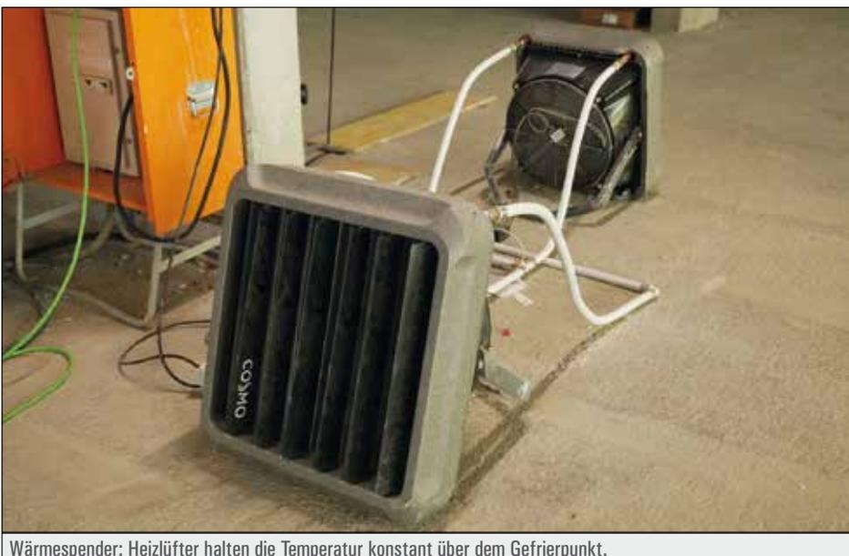
Wärmespender: Heizlüfter halten die Temperatur konstant über dem Gefrierpunkt.
